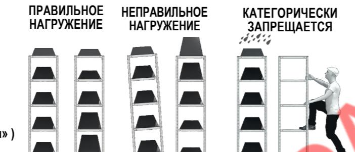
Категорически запрещается вставлять на полки, опираться на элементы стеллажа, опираться на стеллажную конструкцию какие-либо предметы. Загрузку и последующее использование полок, установленных выше 1500 мм от уровня пола, необходимо производить с использованием лестницы
